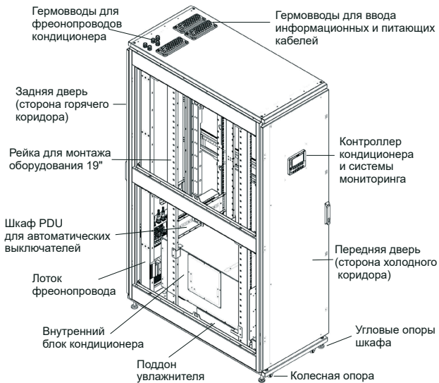
Рисунок 6 – Внешний вид аппаратного шкафа KCOD типа DCI со снятыми боковыми панелями
